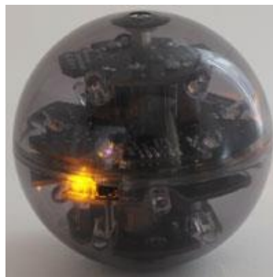
Рис. 2. Мяч с инфракрасными излучателями
