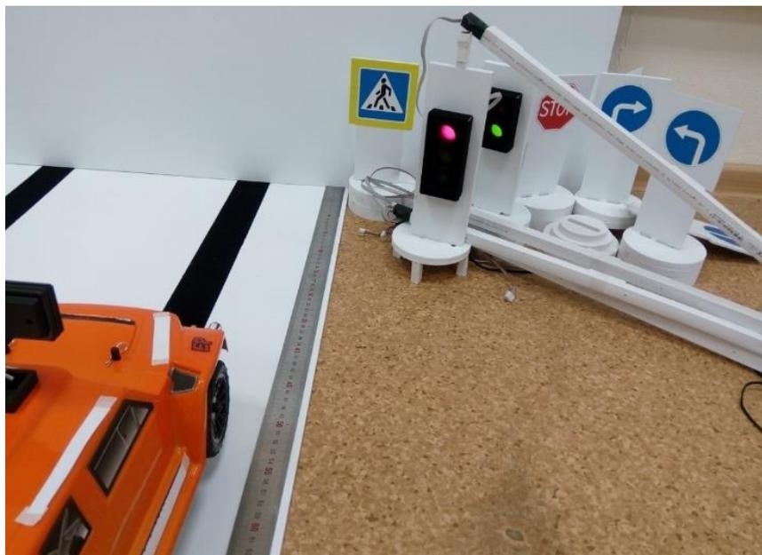
Рисунок. Полигон для тестирования системы технического зрения
