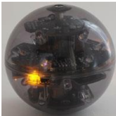
Рис. 2. Мяч с инфракрасными излучателями
